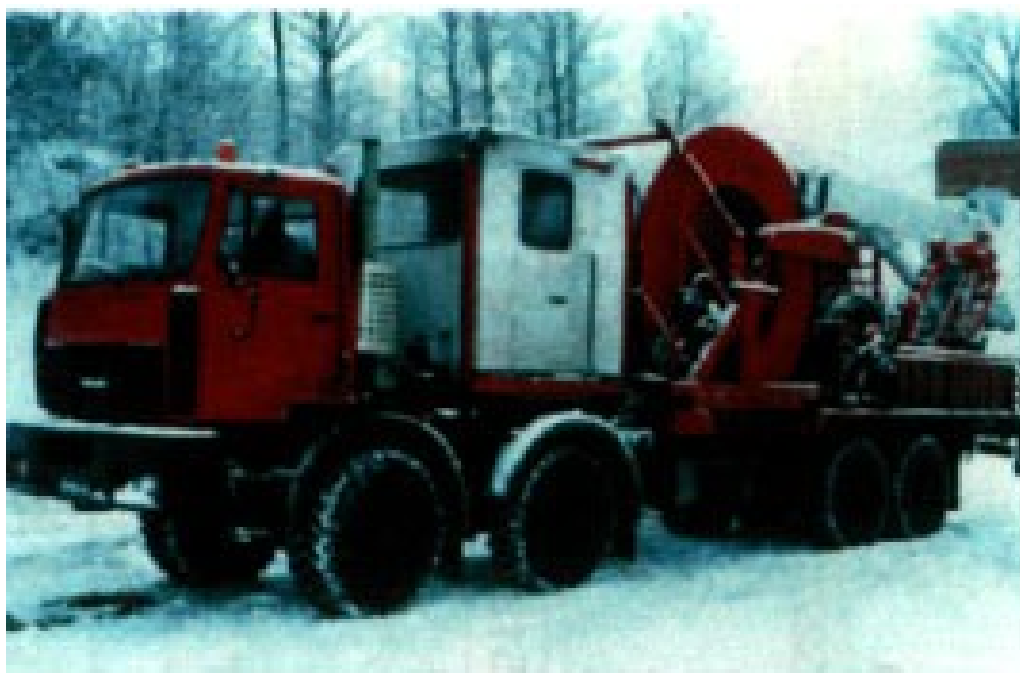
Рис. 4.4. Колтюбинговая установка М20 в транспортном положении
