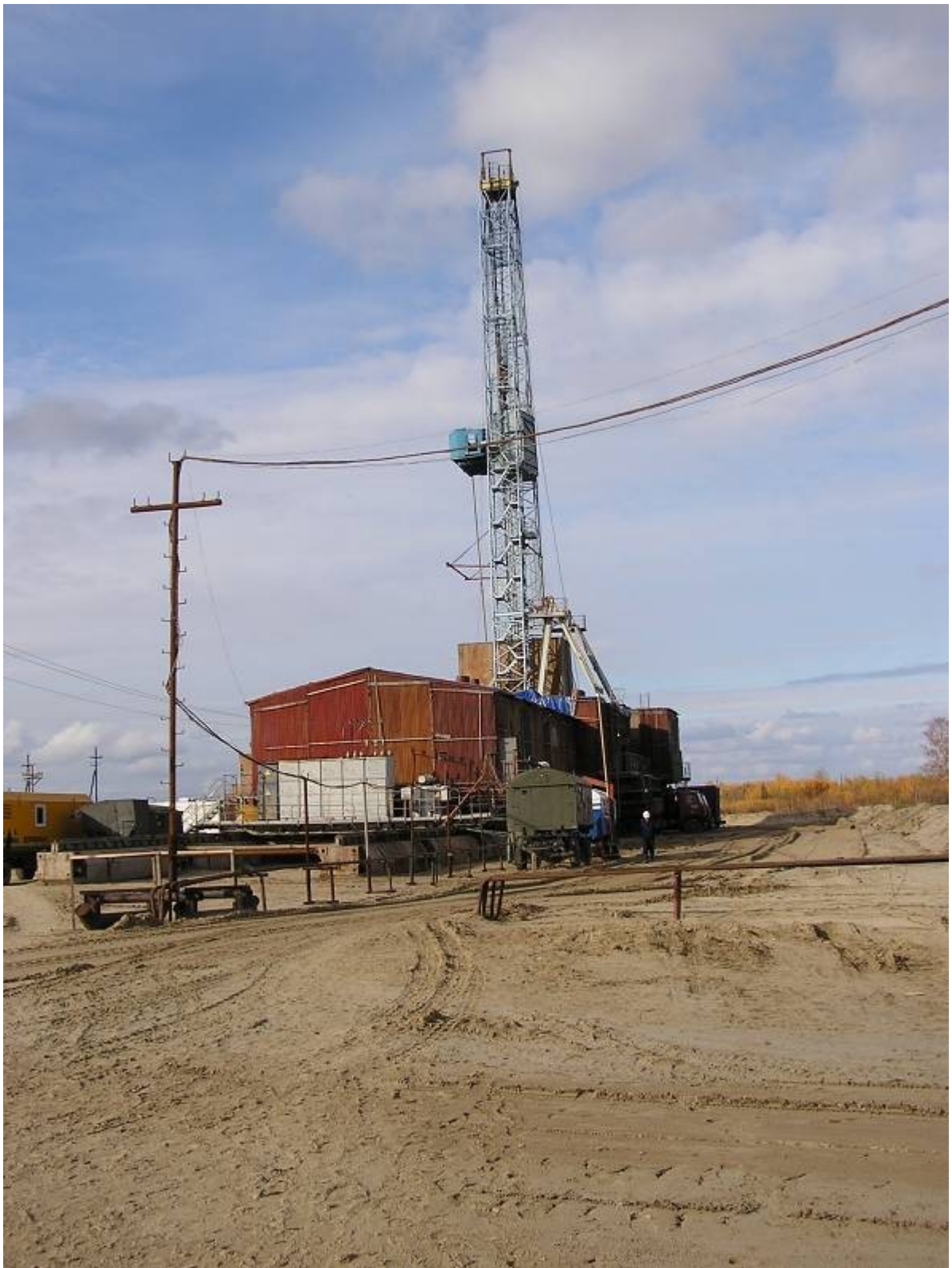
Рис. 4.10. Буровая установка с одноопорной вышкой мачтового типа
