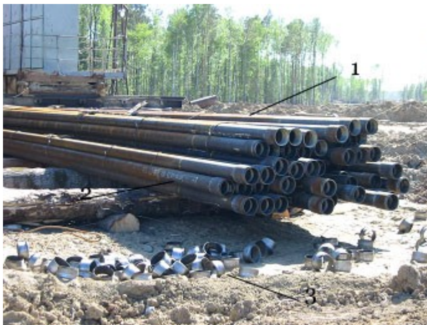
Рис. 4.6. Обсадные трубы, подготавливаемые к спуску в скважину: 1 – обсадные трубы; 2 – маркировка труб; 3 – предохранительные клапаны
