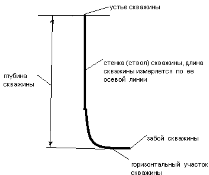
Рис. 4.1. Скважина и ее элементы
