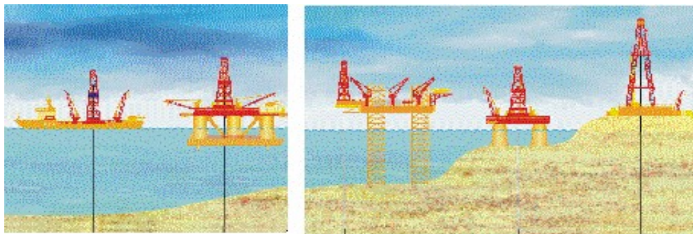
Рис. 4.28. Виды буровых скважин
