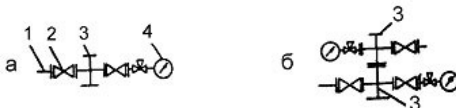
Рис. 7.3. Схемы трубных обвязок фонтанной арматуры: 1 – ответный фланец; 2 – запорное устройство; 3 – трубная головка; 4 – манометр с запорно-разрядным устройством
