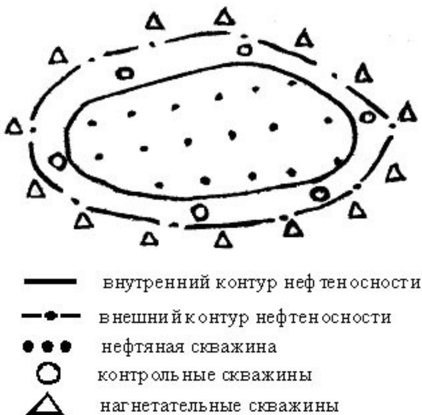
Рис. 6.2. Схема законтурного заводнения
