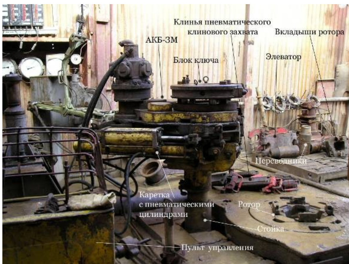
Рис. 4.15. Ключ буровой АКБ-3М
