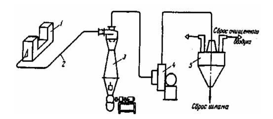
Рис. 8.1. Схема двухступенчатой очистки воздуха от пыли: 1 - пневмат; 2 - воздуховод; 3 - циклон с конусом-коагулятором; 4 – вентилятор; 5 - мокрый пылеуловитель.
