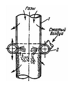
Рис. 5.5. Схема обратной струйной продувки рукавного фильтра: 1 - рукав; 2 - кольцо со щелью и патрубком для подвода сжатого воздуха.
