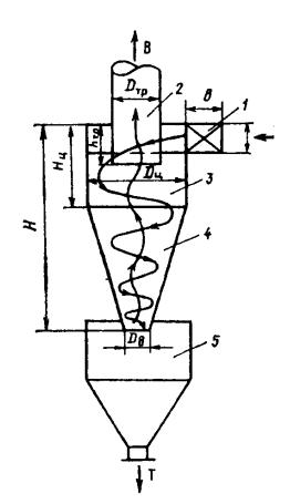
Рис. 4.11. К расчету одиночного циклона:
