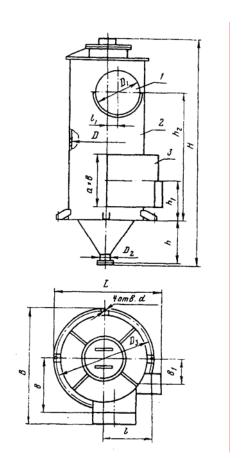
Рис. 6.25. Малогабаритный прямоточный циклон типа КЦТ.
