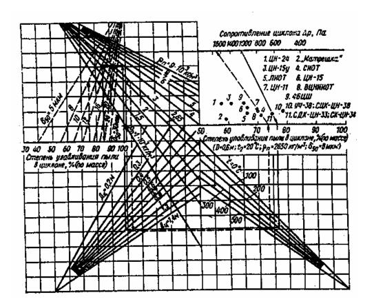
Рис. 4.12. Номограмма для определения эффективности циклона.
