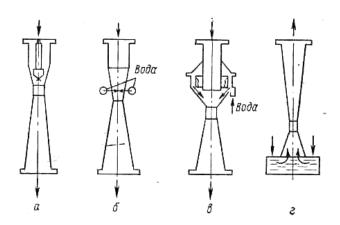
Рис. 6.19. Конструкции труб-распылителей: a — центральный (форсуночный) подвод жидкости;  $\delta$  — периферийное орошение;  $\epsilon$  — бесфорсуночное орошение.
