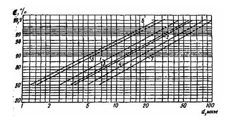
Рис. 4.7. Фракционная эффективность циклонов ЦН НИИОГаз: 1 - ЦН-11; 1 - ЦН-15; 3 - ЦН-15у; 4 - ЦН-24; 5 - СДК-ЦН-33; 6 - СК-ЦН-34.
