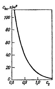
Рис. 5.8. Зависимость коэффициента  $c_2$  от концентрации пыли на входе в фильтр  $c_{\rm ex}$  .
