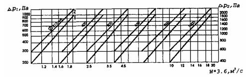
Рис. 6.7. Зависимость перепада давления от расхода газа в
