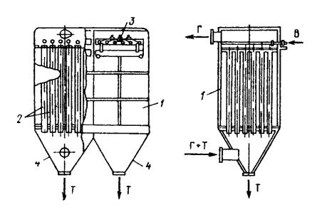
Рис. 5.4. Рукавный фильтр: 1 – корпус; 2 – фильтрующие рукава; 3 – коллектор сжатого воздуха; 4 – сборник пыли.
