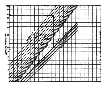
Рис. 4.2. Скорость осаждения в функции размера частиц.
