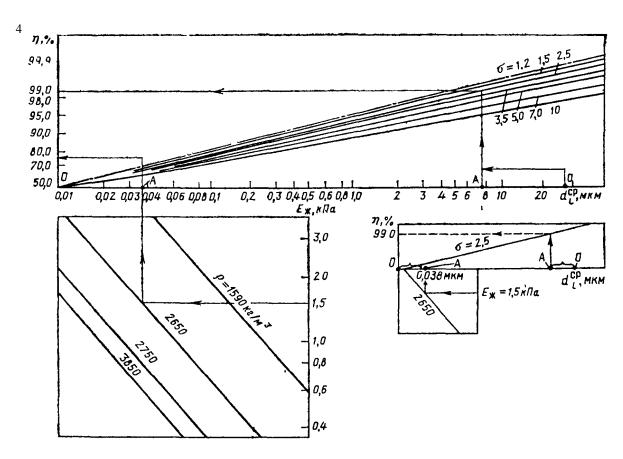
Рис. 6.22. Номограмма для определения степени очистки в КМП (плотность частиц кокса —  $1590 \text{ кг/м}^3$ , кварца —  $2650 \text{ кг/м}^3$ , известняка —  $2750 \text{ кг/м}^3$  и агломерата —  $3850 \text{ кг/м}^3$ ).
