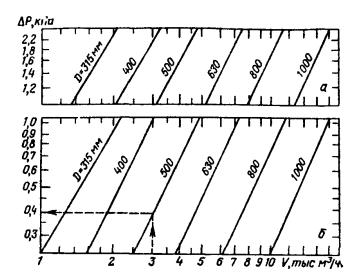
Рис. 6.4. Номограмма для определения гидравлического сопротивления  $\Delta P$  циклона ЦВП в зависимости от расхода газа V и диаметра аппарата D.
