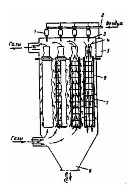
Рис. 5.6. Каркасный рукавный фильтр с импульсной продувкой: 1 - соленоидный клапан; 2 - труба для ввода сжатого воздуха; 3 -сопло; 4 - струя сжатого воздуха; 5 - прибор автоматического управления регенерацией; 6 - рукав; 7 - каркас; 8 - бункер.
