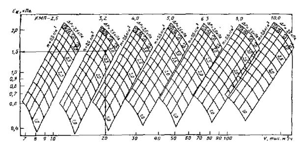
Рис. 6.21. Номограмма для определения удельной мощности контактирования КМП.
