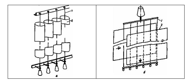
Рис. 7.2. Конструктивная схема электродов: а - электрофильтр с трубчатыми электродами; б - электрофильтр с пластинчатыми электродами; 1 - коронирующие электроды; 2 - осадительные электроды.
