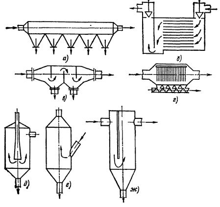
Рис. 4.1. Пылеосадительные камеры и простейшие пылеосадители инерционного действия:
