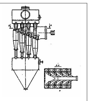
Рис. 4.6. Групповая установка циклонов ЦН.
