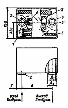
Рис. 5.2. Фильтр грубой очистки ФГ: 1 - форкамера; 2 - входное отверстие; 3 - корпус; 4 - выходное отверстие; 5 - уплотнительное кольцо; 6 - фильтрующий элемент.
