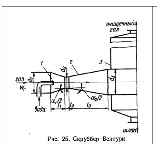
Рис. 6.17. Скруббер Вентури: 1 – форсунка; 2 – сопло Вентури; 3 – каплеуловитель.
