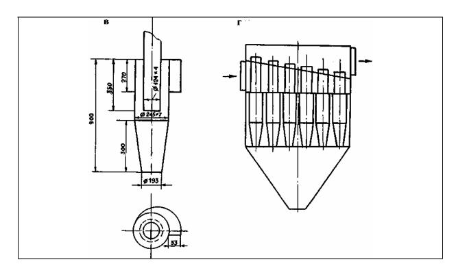
Рис. 4.10. Циклонные элементы батарейного циклона: a - с направляющий аппаратом типа «винт»;  $\delta$  - с направляющим аппаратом типа «розетка»;  $\epsilon$  — вход через укороченные улитки;  $\epsilon$  — четырехзаходный улиточный вход.
