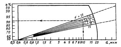
Рис. 6.6. Номограмма для определения степени очистки в циклонах ЦВП
