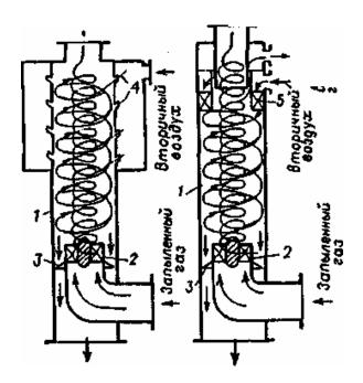
Рис. 4.13. Вихревые пылеуловители соплового (a) и лопаточного ( $\delta$ ) типов: 1 - камера; 2 - лопаточный завихритель; 3 - подпорная шайба; 4 - сопла; 5 - кольцевой лопаточный завихритель.
