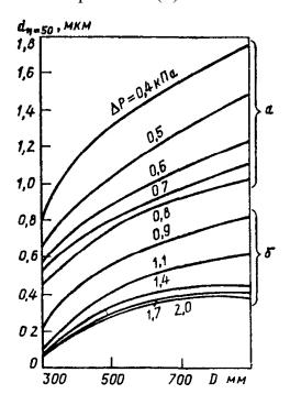
Рис. 6.5. Зависимость диаметра частиц пыли, улавливаемых на 50%  $d_{\eta=50}$ , от гидравлического сопротивления  $\Delta P$  и диаметра циклона ЦВП в основном (a) и скоростном  $(\delta)$  исполнении.
