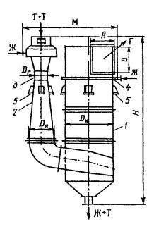
Рис. 6.20. Коагуляционный мокрый пылеуловитель КМП: 1 – сепарационная камера; 2 – труба Вентури;
