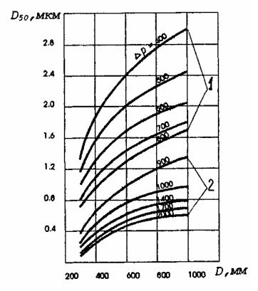
Рис. 6.8. Зависимость  $d_{50}$  от диаметра газопромывателя ЦВП: 1 – циклон в основном исполнении; 2 – циклон с уменьшенным входным сечением.
