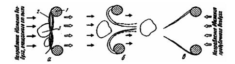
Рис. 5.3. Положение ворса фильтрованной ткани при различных режимах работы: а - рабочее положение ворса: 1 - нить ткани; 2 - нить ворса; 3 - частицы пыли; б - пылевой пробой ткани; в - обратная продувка.
