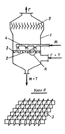
Рис. 6.10. Пенный аппарат ПАСС со стабилизатором слоя пены: 1 – корпус; 2 – провальная тарелка; 3 – стабилизатор пены; 4 – ороситель; 5 – брызгоуловитель.
