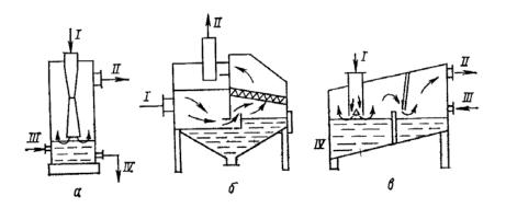
Рис. 6. 12. Скрубберы ударно-инерционного действия: a — импакторный скруббер;  $\delta$  — газопромыватель типа ПВМ;  $\epsilon$  — скруббер Дойля.
