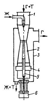
Рис. 6.23. Скруббер Вентури с кольцевой горловой и коническим обтекателем:
