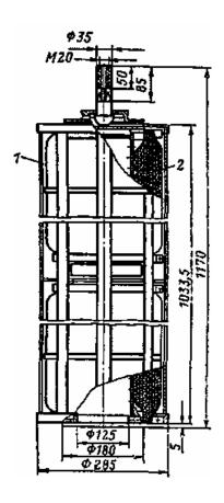
Рис. 5.1. Фильтр ПФТС-500: 1 — каркас; 2 — фильтрующий пакет.
