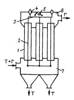
Рис. 7.1. Электрофильтр: 1 — осадительный электрод; 2 - коронирующий электрод; 3 — рама; 4 — высоковольтный изолятор; 5 — встряхивающее устройство; 6 — верхняя камера; 7 — сборник пыли.
