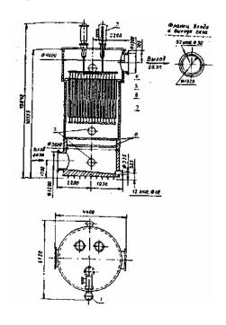
Рис. 7.7. Мокрый электрофильтр типа ЭВМ:
