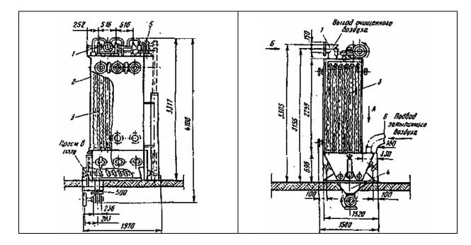
Рис. 5.7. Рукавный фильтр всасывающий типа ФВ (Г4-1БФМ): 1 - клапанные коробки для выхода воздуха; 2 - шкаф металлический; 3 - рукава; 4 - сборник пыли; 5 - электродвигатель; 6 - входной патрубок.
