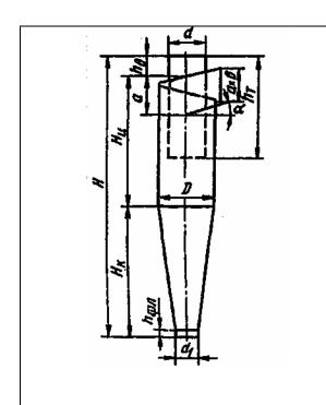
Рис. 4.5. Циклон ЦН конструкции НИИОГаз.
