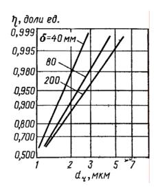
Рис. 6.13. Коэффициенты очистки для пылеуловителя типа ПВМ при различных уровнях воды  $\delta$ .
