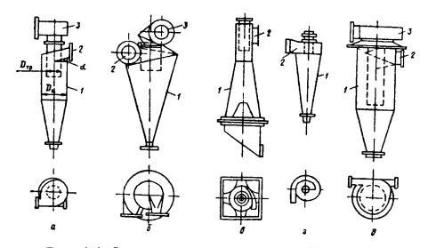
Рис. 4.4. Основные типы конструкций циклонов: а – циклон НИИОГаза; б – СИОТ; в – ВЦНИИОТ; г – СК-ЦН-34; д – ЛИОТ; 1 – корпус; 2 – входной патрубок; 3 – выходная улитка.
