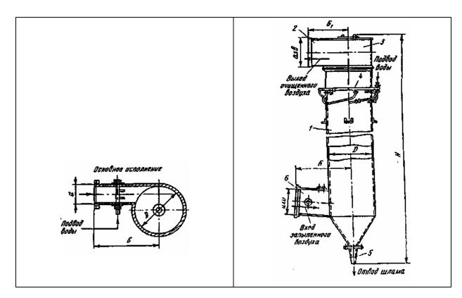
Рис. 6.3. Циклон с водяной пленкой ЦВП:
