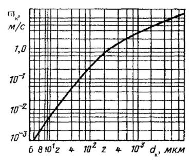
Рис. 6.2. Скорость осаждения капель в полых газопромывателях.
