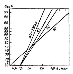
Рис. 6.15. Зависимость фракционной степени очистки  $\eta_{\phi}$  от размера частиц  $d_{\scriptscriptstyle \rm T}$  в ротоклонах типа N.
