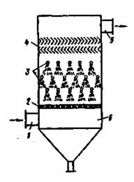
Рис. 6.1. Схема полого газопромывателя: 1 - входной патрубок; 2 - газораспределительная решетка; 3 - форсунки;
