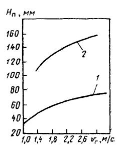
Рис. 6.11. Зависимость высоты слоя пены от скорости газа в аппарате без стабилизатора (1) и со стабилизатором (2).
