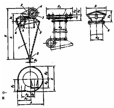
Рис. 4.8. Циклон конструкции СИОТа:
