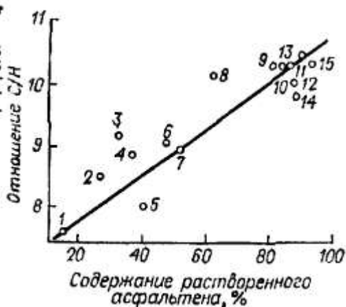
рис. 7. Зависимость растворимости асфальтенов от отношения C/H:
