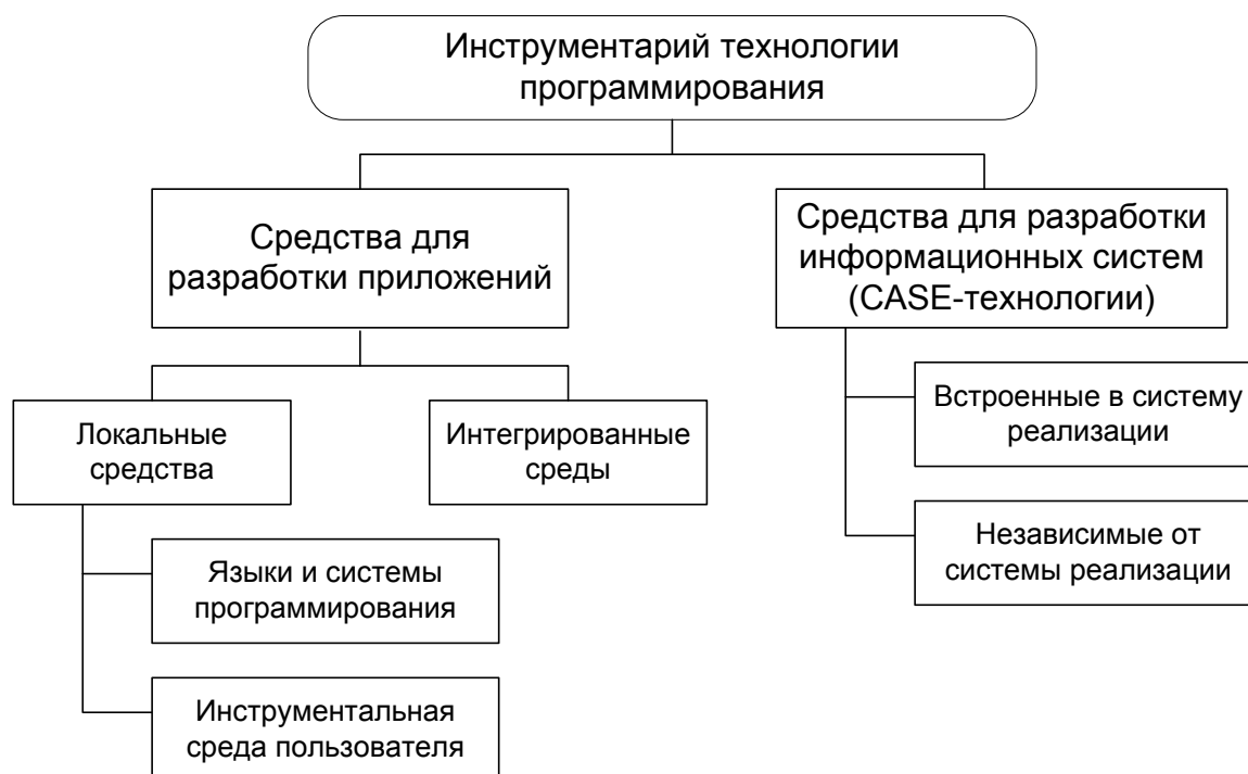
Рис. 7.2 - Классификация инструментария технологии программирования
