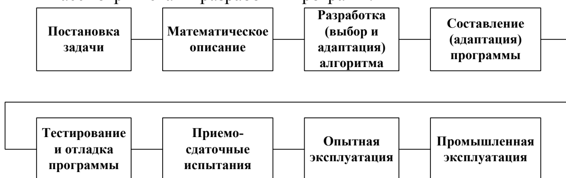
Рис.7.1 - Этапы разработки программного обеспечения.
