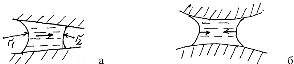
Рис. 10. Перемещение жидкости в капиллярах переменного сечения: а - движение жидкости под действием разности капиллярных давлений; б - стягивающее действие капиллярного давления
