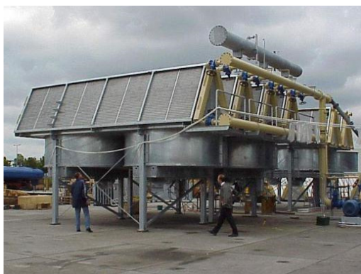
Рис. 2.5. АВО дельтаобразного типа (АВОГ-1) [50, 51].
