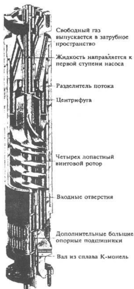
Рисунок 3 - Центробежный сепаратор фирмы REDA [5]
