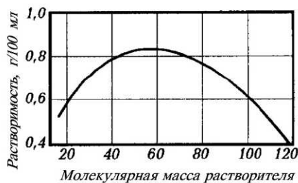
Рисунок 1.10 – Зависимость растворимости парафина с температурой плавления 54 °С в сжиженных и жидких парафиновых углеводородах от их молярной массы
