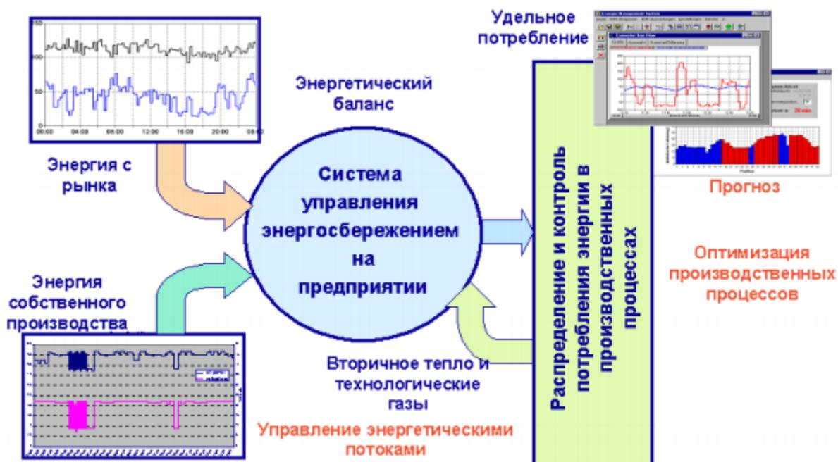
Рис. 1.2. Схема системы управления энергосбережением на предприятии [20]
